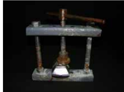
Figura 8. Proceso de acrilizado del conformador. Muflas.
